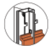
Offenes Fugenprofil, Fuge 8 mm
